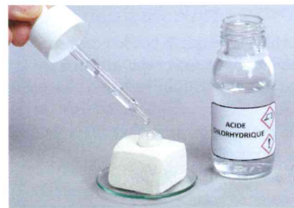
Fig. 2 : Acide chlorhydrique sur calcaire.
